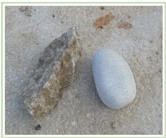
Comparación entre piedra de cantera que ha echado la J. de Costas y canto rodado del Girona
